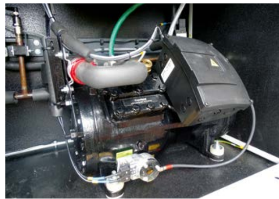
Compresseur équipé d'un module de diagnostic CoreSense incorporé.
