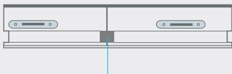
MATRIX 150 : Isolatie 30x20 mm tussen 2 panelen
