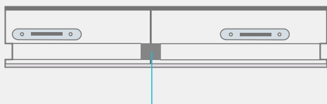
MATRIX 150 : Isolation 30x20 mm entre 2 panneaux
