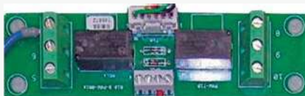
Carte électronique d'interface T10 avec connexions numériques et relais
